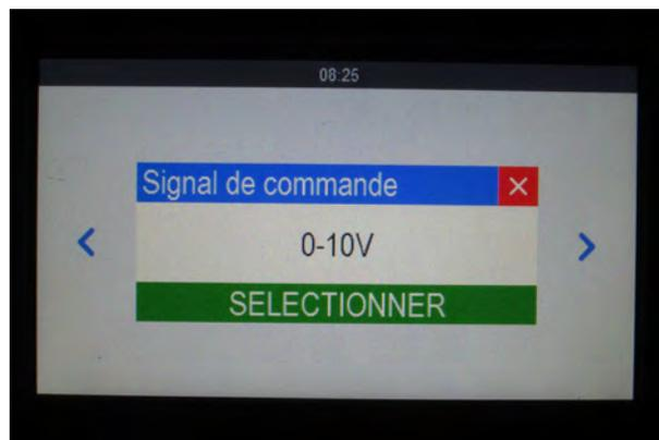
7. L'AGRIBOX pro est maintenant prêt pour les luminaires 0-10 V.
