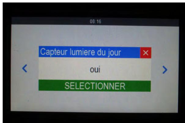
7. Appuyez sur les deux flèches vers le bas jusqu'à afficher « Étalonnage lumière extérieure ».
