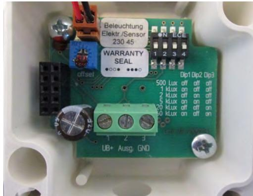
2. Mettez les commutateurs DIP sur la position 20 kLux. C'est le paramètre par défaut à la livraison :
